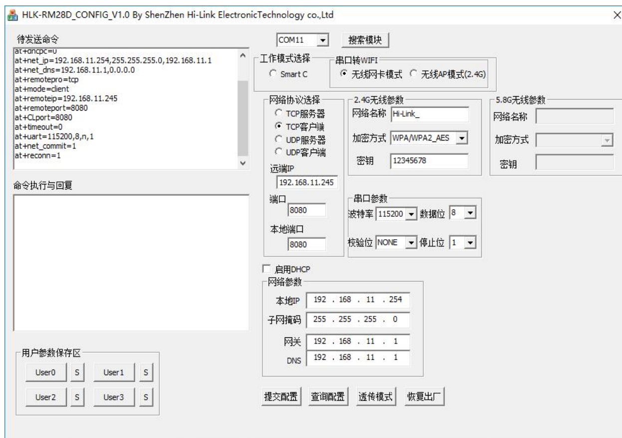
图 26. 串口配置工具生成指令
