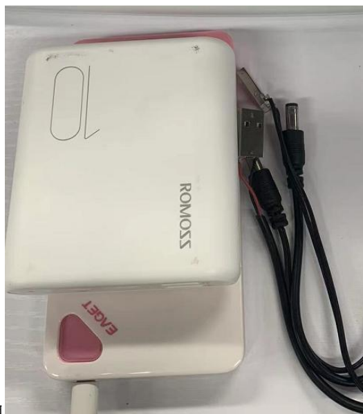
测试电源：两个 5V2A 充电宝供电
