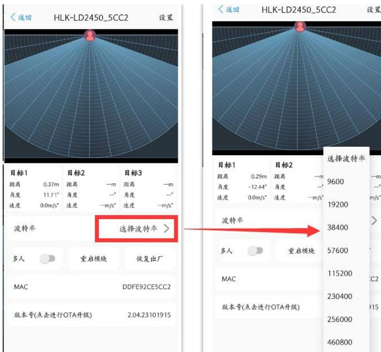
(4) 开启多人检测功能，开启多人后，可以探测到最多三个目标。
