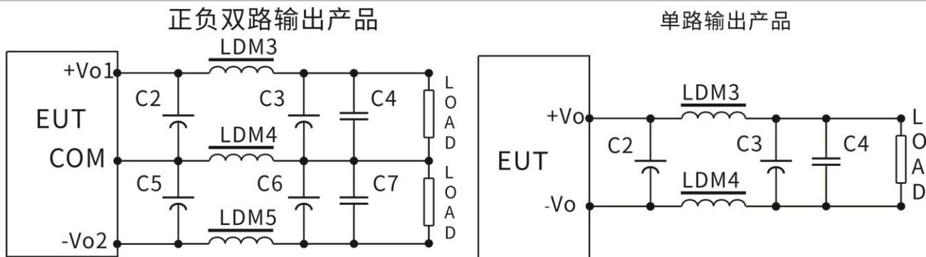
对纹波&噪声要求一般时，外围推荐仅使用 C2、C5 即可；对纹波&噪声要求严格时；推荐使用上图电路。
