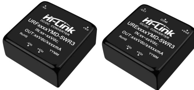
UR(E)F\_YMD-5WR3 系列产品输出功率为 5W, 4:1 宽电压输入范围, 效率高达 86%, 3000VDC 常规隔离电压, 允许工作温度 -40°C to +85°C, 具有输入欠压保护, 输出过压、过流、短路保护功能, 裸机满足 CISPR32/EN55032 CLASS A, 广泛应用于医疗、工控、电力、仪器仪表、通信、铁路等领域。
