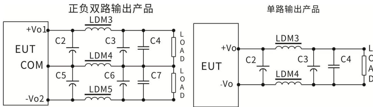
对纹波&噪声要求一般时，外围推荐仅使用 C2、C5 即可；对纹波&噪声要求严格时；推荐使用上图电路。
